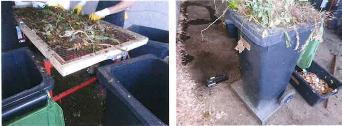
Abb. 18: Sortiertisch (links), Verwiegung der aussortierten Fraktionen (rechts)
